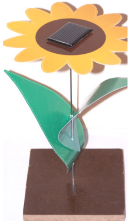
▲ De Tournesol in opgebouwde toestand: in het licht gaat de bloem draaien door de zonnecel op het hart van de bloem.
